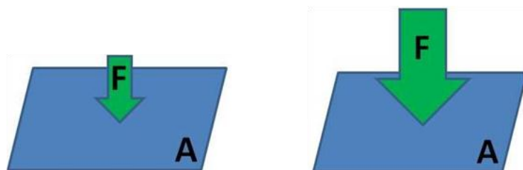
Abb. 2: Vergrößerung des Drucks durch Vergrößerung der Kraft
